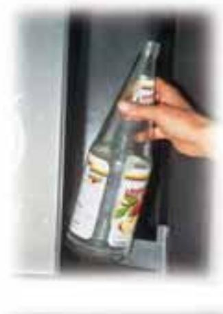
ren die Leergutrückgabe zunehmend mit Automaten, die Flaschen und Träger automatisch erkennen und das Pfand ausrechnen.
