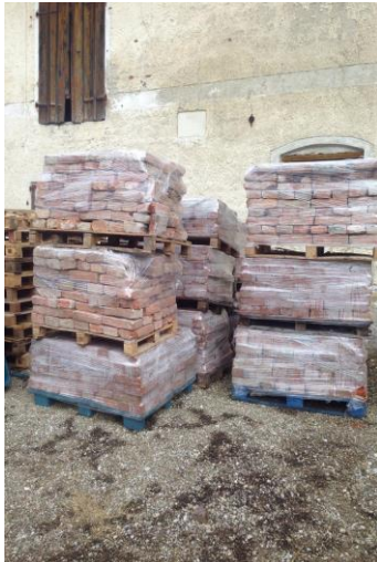
Abb. 7: Zwischengelagerte, wieder verwendbare Ziegel (Foto Pacello)
