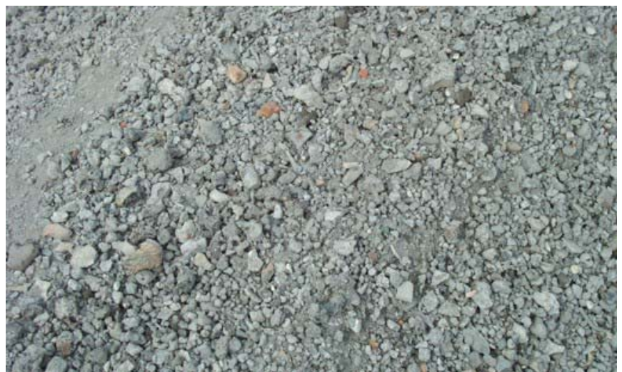
Abb. 2: Aufbereitete und gealterte MV-Asche
