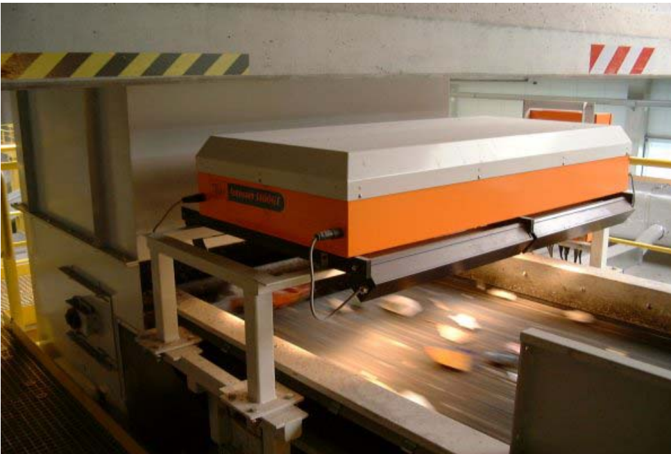
Abb. 2: NIR-Modul in einer LVP-Sortieranlage
