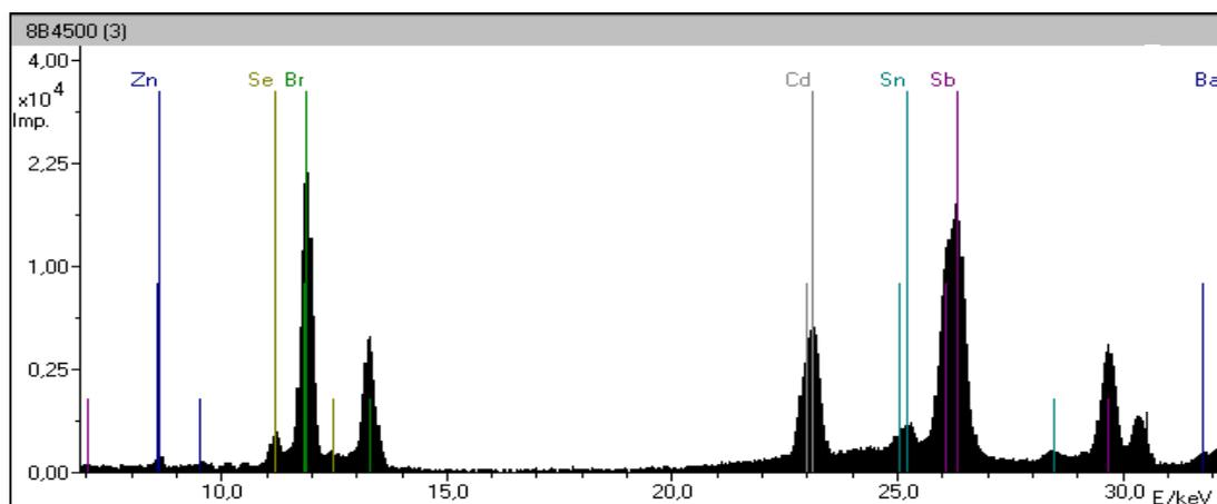
Abb. 1: EDRFA Spektrum des Gehäusekunststoffs eines TV-Gerätes (Al<sub>2</sub>O<sub>3</sub> Target; Messzeit 100 s)
